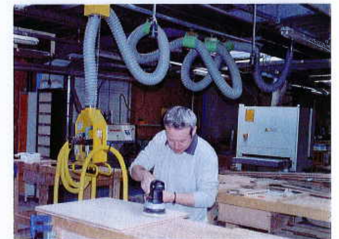
Le boîtier mobile monté sur rail est une solution intéressante et efficace pour le branchement des outils portatifs.
