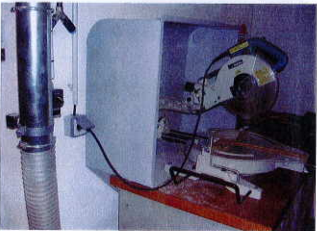
Les sciures émises par une scie radiale sont toujours très difficiles à capter. Un généreux carter sur l'arrière, englobant l'ensemble de la machine, est une solution astucieuse.
