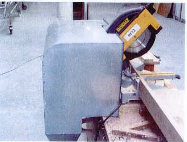
Un carter bien conçu est remarquablement efficace et ne gêne pas le pivotement de la scie radiale.
