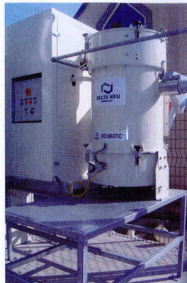
Centrale de dépollution haute dépression pour tous types d'applications, sauf poussières collantes.
