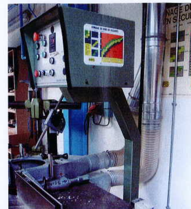
Double raccordement de la toupie indispensable sur le carter et sous la table.
