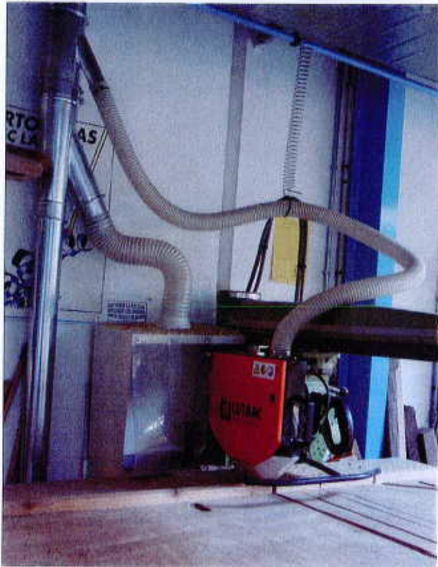
Cette scie radiale bénéficie du double système : encoffrement de la lame et carter de récupération des projections de sciures.
