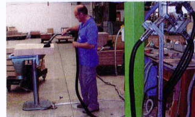
Il faut toujours préférer l'aspiration au balayage, aussi bien pour le dépoussiérage des pièces que pour la propreté de l'atelier.
