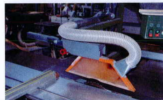
Pour être efficace, la cape sur la scie circulaire doit être englobante et directement reliée au système général.
