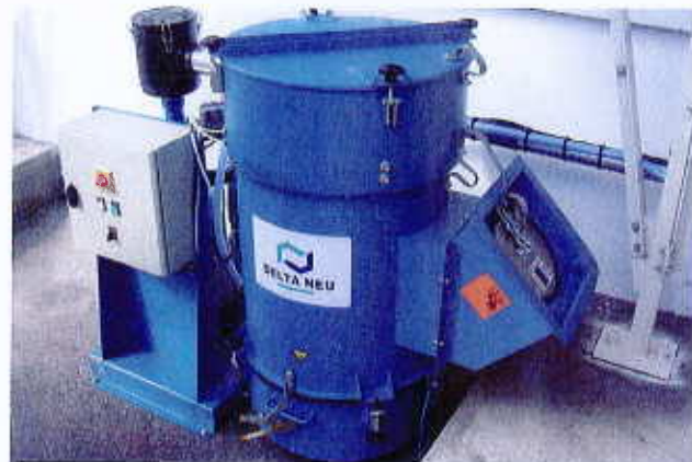
Centrale de dépollution haute dépression. Concentration de poussières maxi de 5 g/m 3 , et débit d'air de 300 à 600 m 3 /h, nettoyage par air comprimé, automatique en fonctionnement avec séquenceur.
