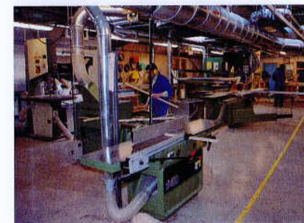
Le raccordement de la raboteuse exige un tuyau de sortie de forte section.
